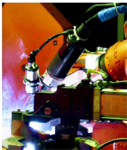
Optimal schweißen: Über ein Mikrofon steuert ein Computer den Roboter.
